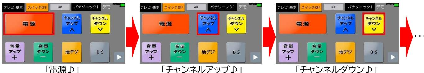
操作したいボタンの枠が赤くなった時に入力スイッチを押すと、リモコンユニットから赤外線信号が発信されます。この操作を繰り返すことで、身体のわずかな動きだけでテレビの基本的な操作を可能とします。また、ご利用者一人ひとりに合わせて、設定を細かくカスタマイズして、使いやすいように調整することができます。
