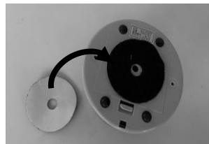
【図2 赤外線ユニットへマジックテープ貼付け】
