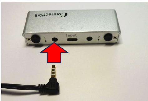
ジャックの1、2のいずれに接続するかは、行いたい操作と接続する機器の設定に依存します。機器側の設定も確認してください。入力1と入力2の端子の両方にスイッチをつないで操作することもできます。
