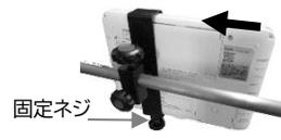
2. ファイン・チャット取付金具の固定ネジを、ファイン・チャットの固定用ネジ穴に合わせ、時計回りに回してしっかりと固定する。
